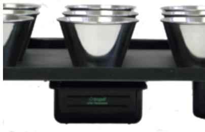
Su función es mantener la cera en estado líquido para aplicarla sobre el trabajo con espátula o pincel. Funde entre 70° C y 80 ° C Debería contar con termostato para mantener una temperatura constante. Si la cera sobrepasa la temperatura de fusión produce humo tóxico e incluso puede llegar a arder.
